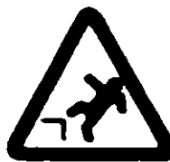
Warnung vor Absturzgefahr
