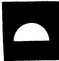
Material und/oder Ausrüstung zur Brandbekämpfung (allgemein)
