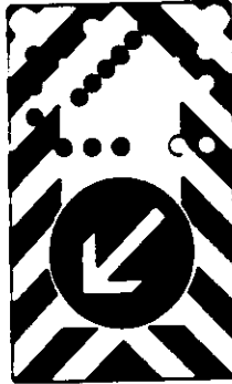
fahrbare Absperrtafel mit Blinkpfeil
