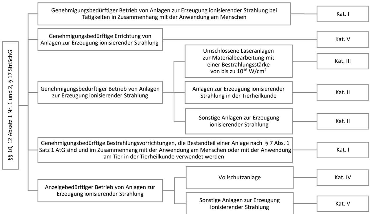
Abbildung 1: Entscheidungsbaum für den Betrieb und die Errichtung von "Anlagen" (§§ 10, 12 Absatz 1 Nr. 1 und 2, § 17 StrlSchG)
