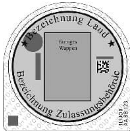
Abbildung 4: Plakettenträger mit Zerstörungsbild
