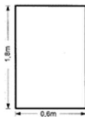
Abbildung 6: Rechteck (Markierung der seitlichen Begrenzungen der unbefestigten Nicht-Instrumentenlandebahn)
