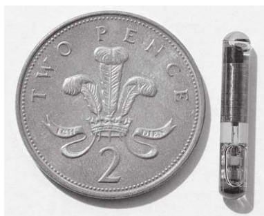
Glastransponder für die Implantation unter die Haut
