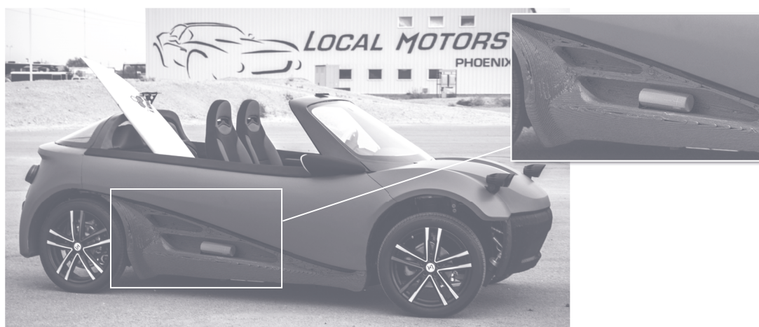
Computerdarstellung und Detailansicht des LM3D Swim
