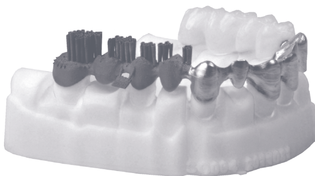
Brücke und dentaltechnisches Modell aus additiver Fertigung
