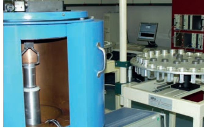
Germaniumdetektor in Bleiabschirmung (links) und Probenwechsler (rechts): in den silbernen Containern befinden sich die auf Gammastrahlung zu untersuchenden Baustoffe.
