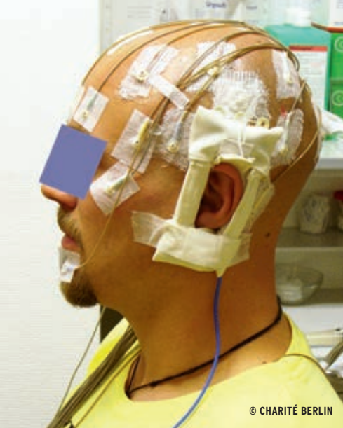
Testperson mit am Kopf aufgeklebten EEG-Elektroden und der am linken Ohr befestigten Flachantenne zur Exposition
