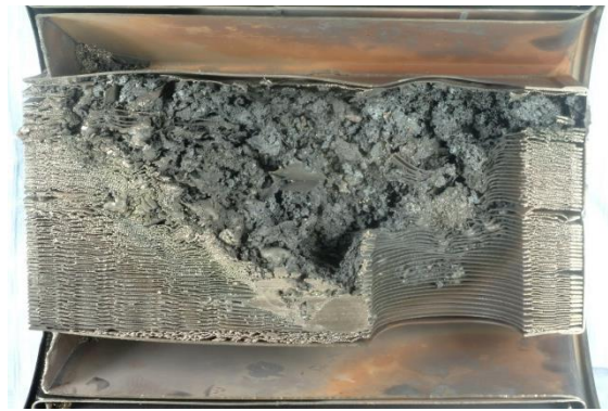
Abbildung 2: Folgen einer unerwünschten Partikelfilterregeneration, DPF - Durchbrand Rußbeladung = 100 [g], T_{\text{Regeneration}} = 650\text{ }^{\circ}\text{C} [6]
