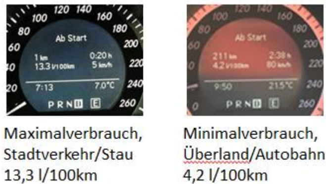
Abbildung 33: Spannweite des Fahrzeugverbrauches bei einer Normangabe von 6,0-6,5 l/100km. Die Verbrauchsspannweite ist bedingt durch Individualisierungsmöglichkeiten der Fahrzeuge (Reifen, Fahrwerk, Ausstattungsumfänge, ...)
