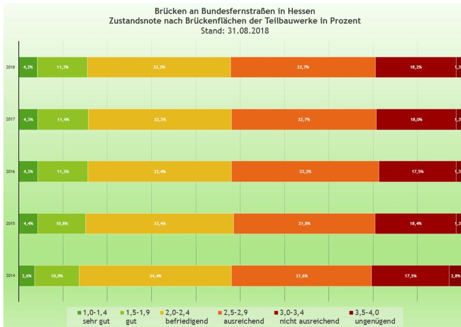
Wie der Grafik zu entnehmen ist, ist der Anteil der Brücken mit einer sehr guten bis guten Zustandsnote um ca. zwei Prozentpunkte angestiegen.
