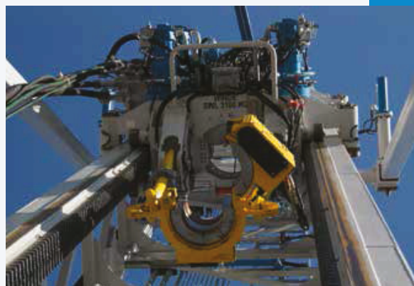
Der Hubschlitten wird innerhalb des Zahnstangenmasts per Fernbedienung auf und ab bewegt.
