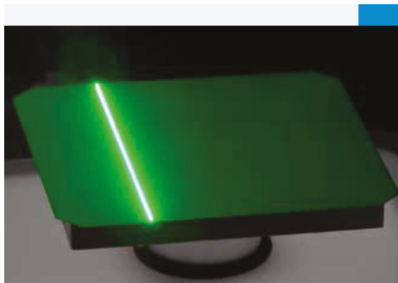
Mithilfe eines Lasers wird lokal auf der Solarzellen-Vorderseite ein selektiver Emittor erzeugt, um den Wirkungsgrad zu steigern.
