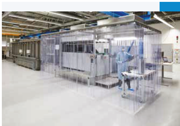
Inline-Epitaxieanlage ProConCVD im NexWafe Technologiezentrum
