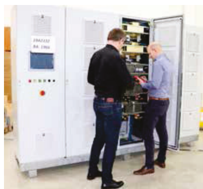
Überprüfung der wassergekühlten Drosseln an einem der vier 3-MVA-Frequenzumrichter des Gesamtprüfstandes
