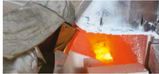
Blick auf flüssige Glasschmelze im Bereich der Gemengeeinlage einer Glasschmelzwanne
