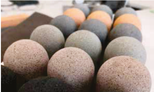
Probegeometrien aus Kernsand mit verschiedenen Aerogel-Additiven
