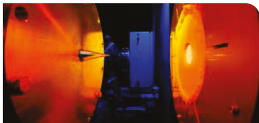
Molekularstrahl-Probennahme: Düse-Skimmer-System für Untersuchung der Chemie in reaktiven Strömungen
