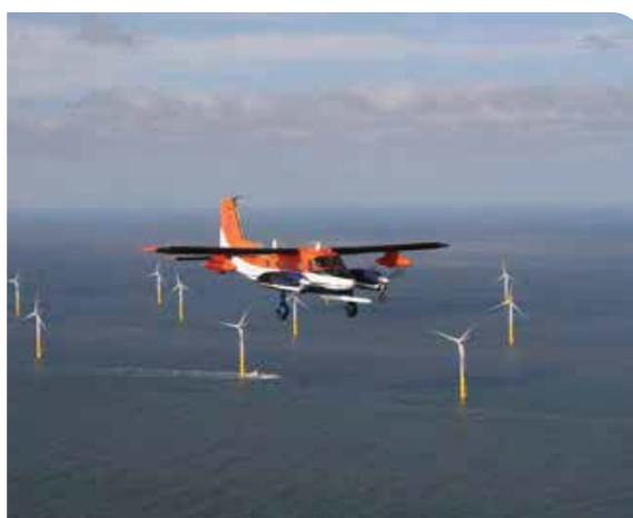
Ein Forschungsflugzeug liefert hochaufgelöste meteorologische Daten, mit denen die Windbedingungen in Offshore-Windparks präzise analysiert werden können.
