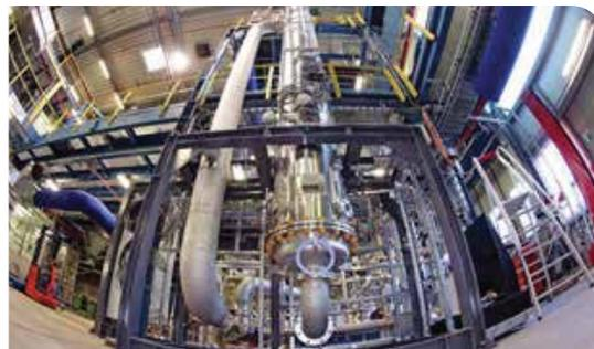
Im Bioreaktor setzen Mikroorganismen Kohlendioxid und Wasserstoff zu Spezialchemikalien um (Chemikaliensynthese).
