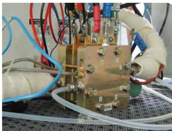
Testzelle für Versuche mit den neuen Katalysatoren
