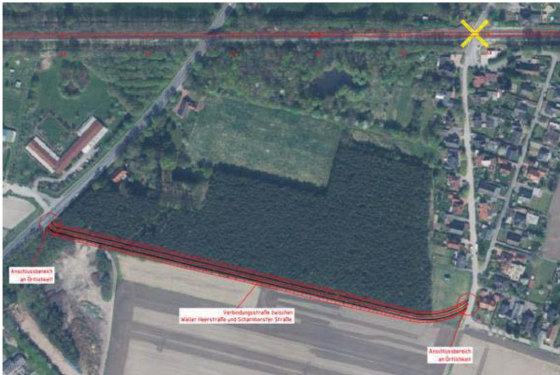
Abbildung 3: Variante 2 für die Schließung des BÜs bei km 5,777<sup>3</sup>
