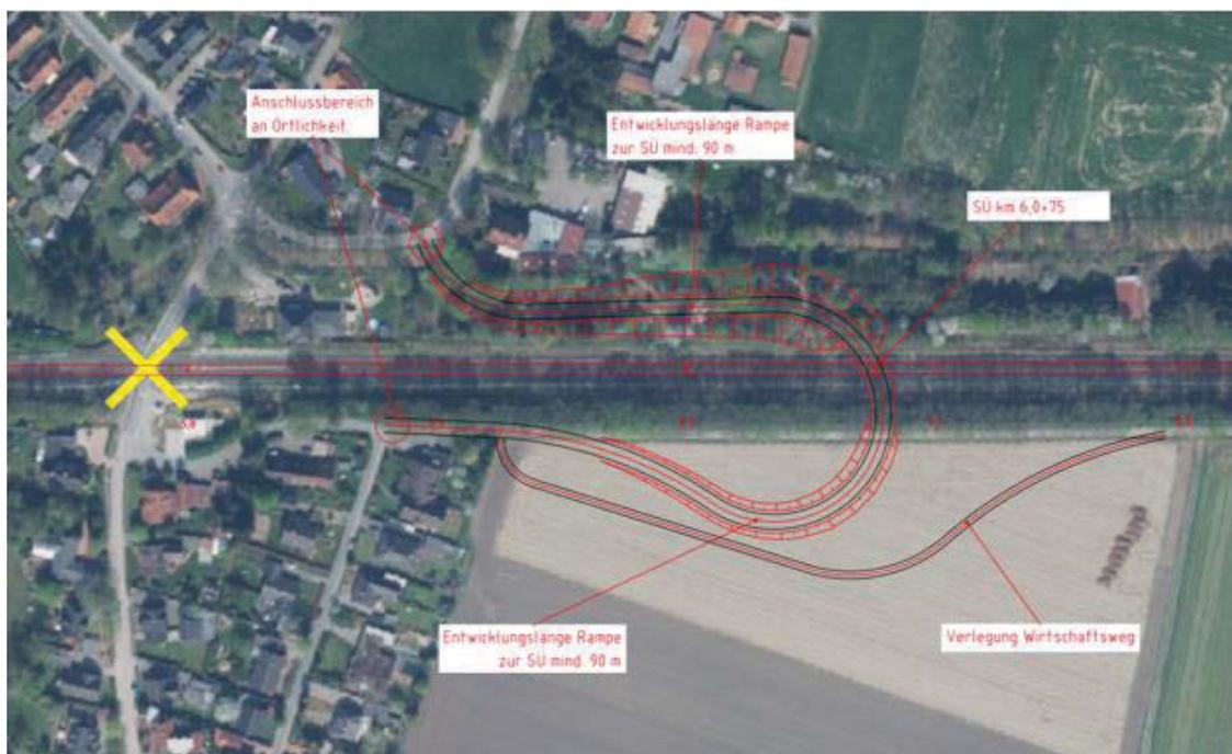
Abbildung 2: Variante 1 für die Schließung des BÜs bei km 5,777<sup>2</sup>
