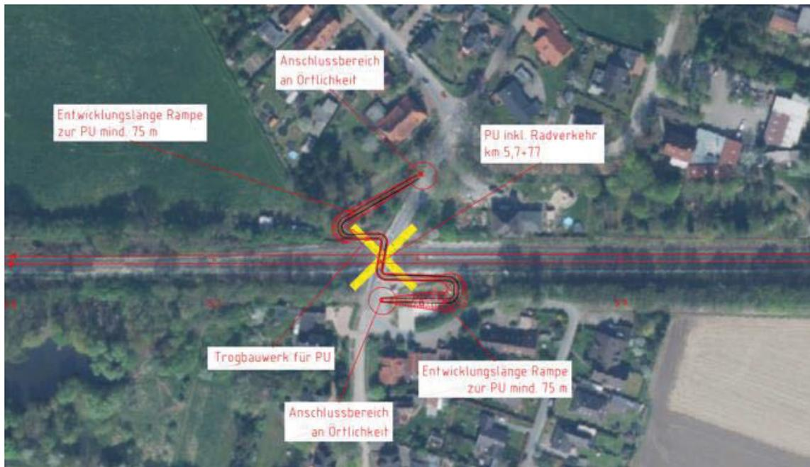
Abbildung 4: Tunnel als Querungsmöglichkeit für Radfahrer und Fußgänger in Walle<sup>4</sup>
