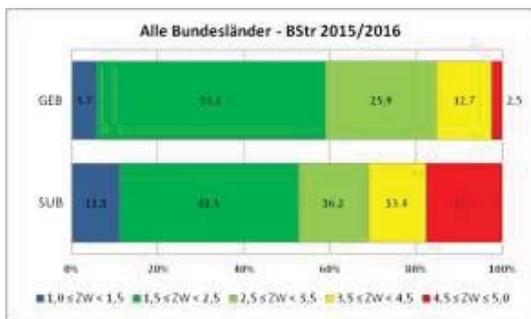
Der Gebrauchswert aller Streckenabschnitte auf Bundesstraßen zeigt, dass sich 5,7 % in einem sehr guten Zustand (blauer Bereich) befinden. Eine gute bis befriedigende Gebrauchstauglichkeit weisen 79,1 % aller Streckenabschnitte auf. Der Anteil an Streckenabschnitten, der einer intensiven Beobachtung und vorrangigen Planung von baulichen Maßnahmen bedarf, liegt bei 12,7 % (gelber Bereich).
