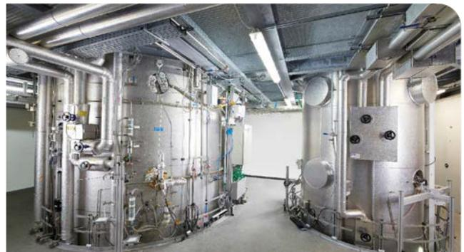
Die circa 10 Meter hohe Versuchsanlage THAI besteht aus zwei Versuchsbehältern, die flexibel separat oder kombiniert zur Untersuchung von Phänomenen im Sicherheitsbehälter von Kernkraftwerken genutzt werden.
