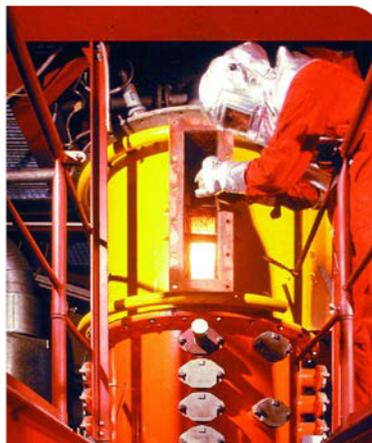
Feuerungskonzept inklusive eines speziell entwickelten Oxyfuel-Ofenbrenners erstmals in einer Pilotanlage getestet.
