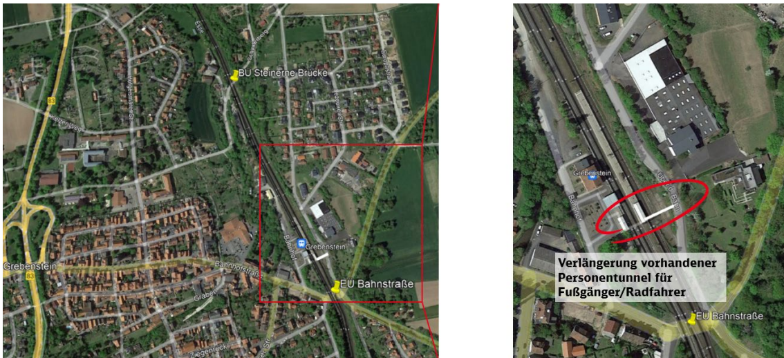
Abbildung 9: Verlängerung Personentunnel im Bahnhof Grebenstein als alternative Quersungsmöglichkeit für Fußgänger/Radfahrer zu BÜ Nr. 14
