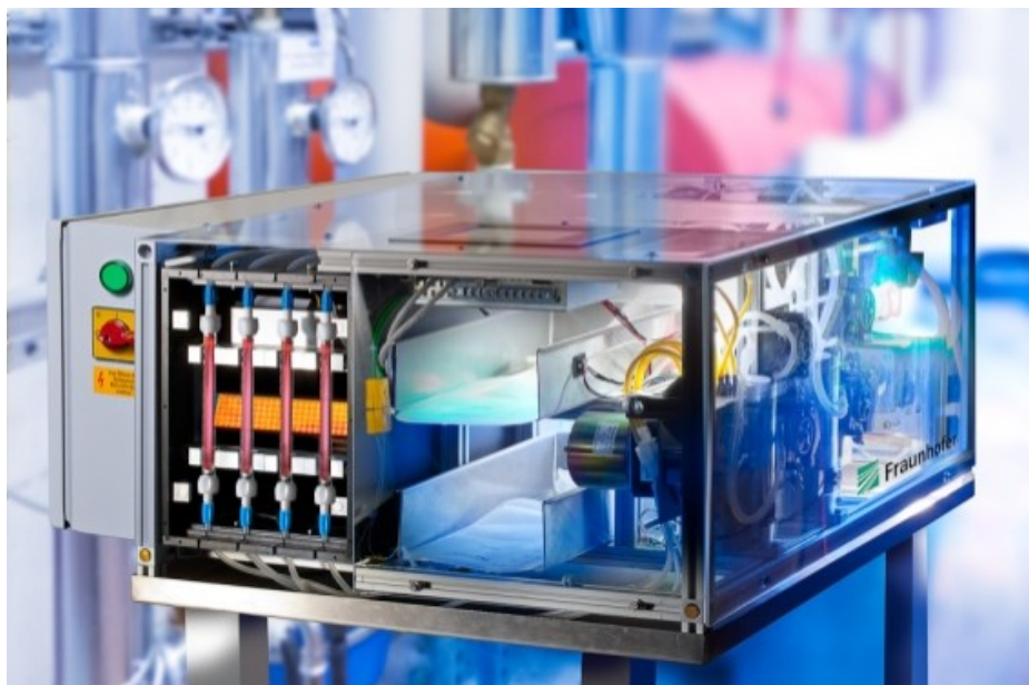
Abb. 4.6 Biologischer Breitbandsensor AquaBioTox
