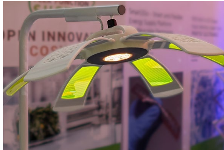
Prototyp einer Operationsleuchte mit Organischen Leuchtdioden (OLEDs) auf ultradünnem Glas, entwickelt im Rahmen deutsch-japanischer Cluster-Kooperation
