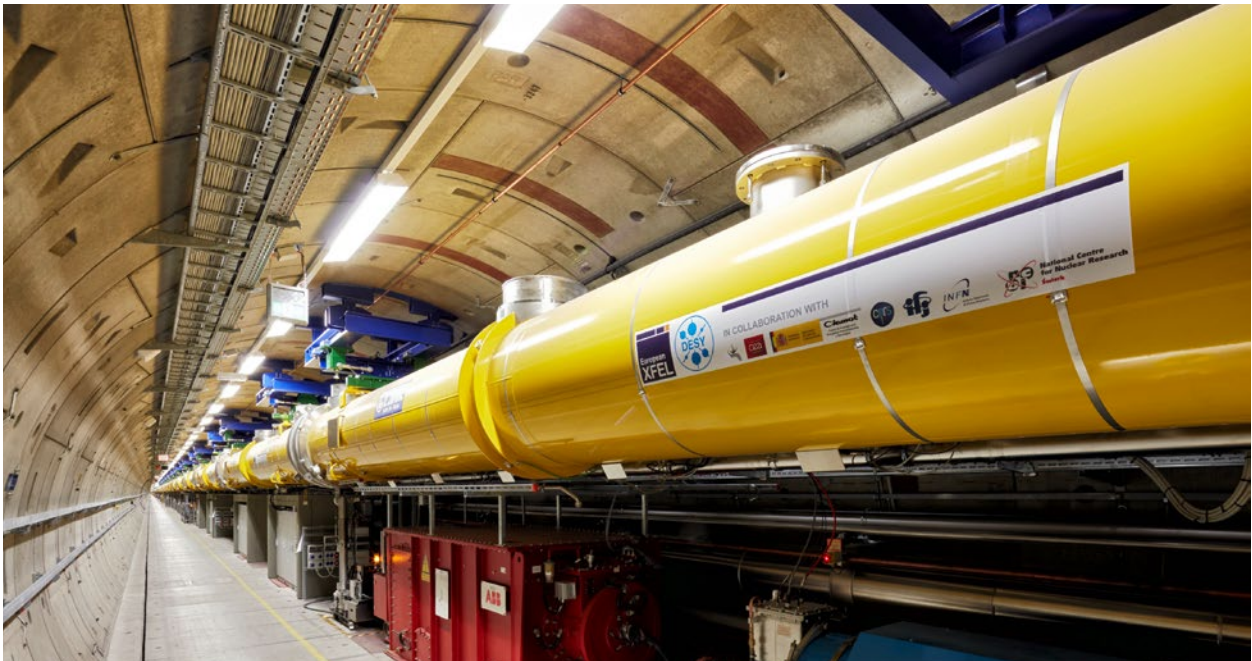
27 000 Lichtblitze in der Sekunde und eine milliardenfach höhere Leuchtstärke als klassische Röntgenquellen liefert der bei Hamburg gebaute weltweit einzigartige Freie-Elektronen-Laser European XFEL seit 2017.
