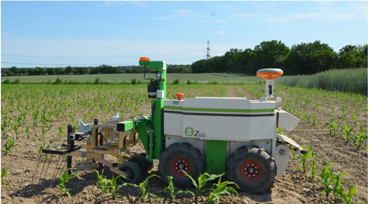
Ein Agrarroboter ist im Einsatz zur Unkrautkontrolle auf dem ZALF-Landschaftslabor patchCROP.
