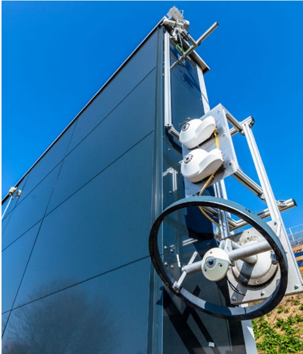
Messtechnik zur Erfassung der solaren Einstrahlung an einem Fassadenteststand des Instituts für Solarenergieforschung GmbH
