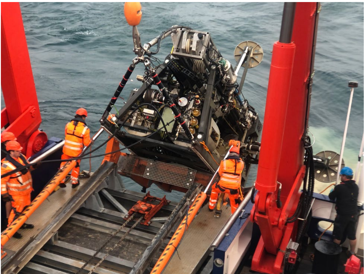
Das Meeresboden-Bohrgerät MARUM-MeBo70 an Bord des deutschen Forschungsschiffs „Maria S. Merian“
