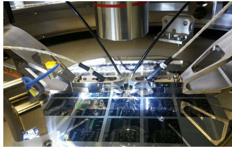
Waferlevel-Charakterisierung integrierter photonischer Komponenten am automatischen Waferprober am Fraunhofer-Institut für Elektronische Nanosysteme ENAS
