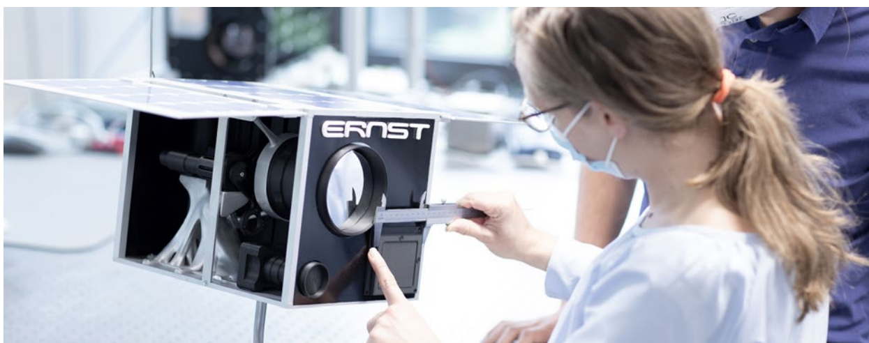
Der Kleinsatellit ERNST, entwickelt vom Fraunhofer-Institut für Kurzzeitdynamik, Ernst-Mach-Institut, der u. a. für die Detektion von Raketenstarts eingesetzt werden könnte
