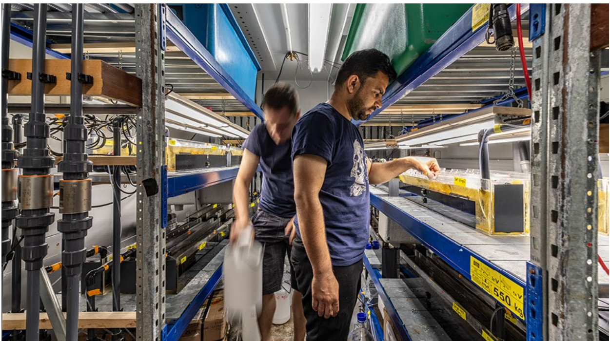
In den mobilen Laborcontainern des Helmholtz-Zentrums für Umweltforschung (UFZ) können ökologische Prozesse in Fließgewässern fast so natürlich wie unter Freilandbedingungen und so kontrollierbar wie im Labor analysiert werden.
