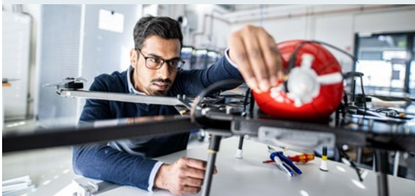
Arbeiten an einer brennstoffzellenbetriebenen Hexacopter-Drohne im Fuel Cell Lab des ZAL TechCenters
