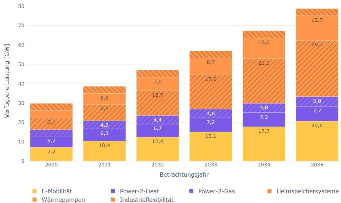
Abbildung 14: Verfügbare Leistung der Nachfrageflexibilitäten im Zeitpunkt der Jahreshöchstresiduallast in Deutschland im Zielszenario
