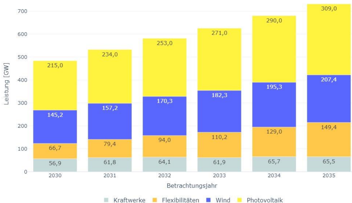
Abbildung 8: Entwicklung der Kraftwerke, der Flexibilitäten sowie Windenergie- und PV-Anlagen in Deutschland im Zielszenario
