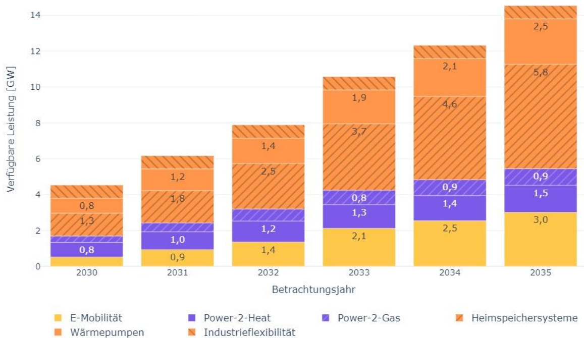
Abbildung 28: Verfügbare Leistung der Nachfrageflexibilitäten im Zeitpunkt der Jahreshöchstresiduallast in Deutschland im VE-Szenario
