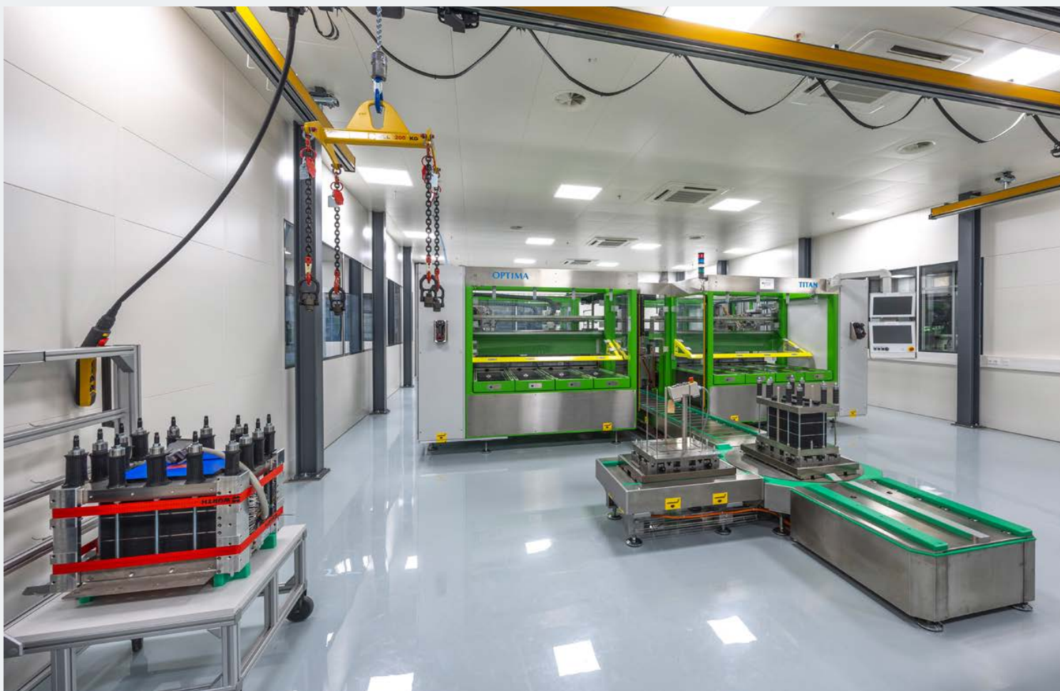
Elektrolyseure in Serie bringen: Die Stack-Fertigungslinie im Gigahub von Quest One in Hamburg trägt zu diesem Ziel der Wasserstoff-Leitprojekte bei.
