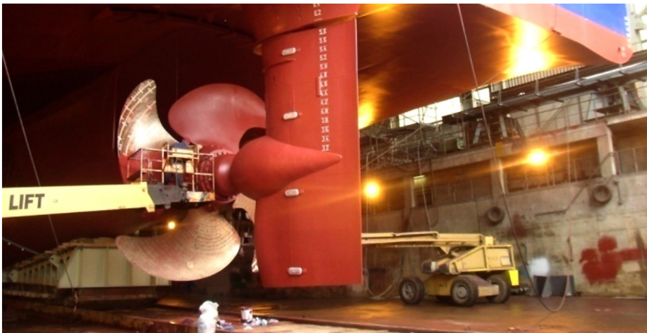
Abbildung 4.3 Twistiertes Ruder mit integrierter Propulsionsbirne
