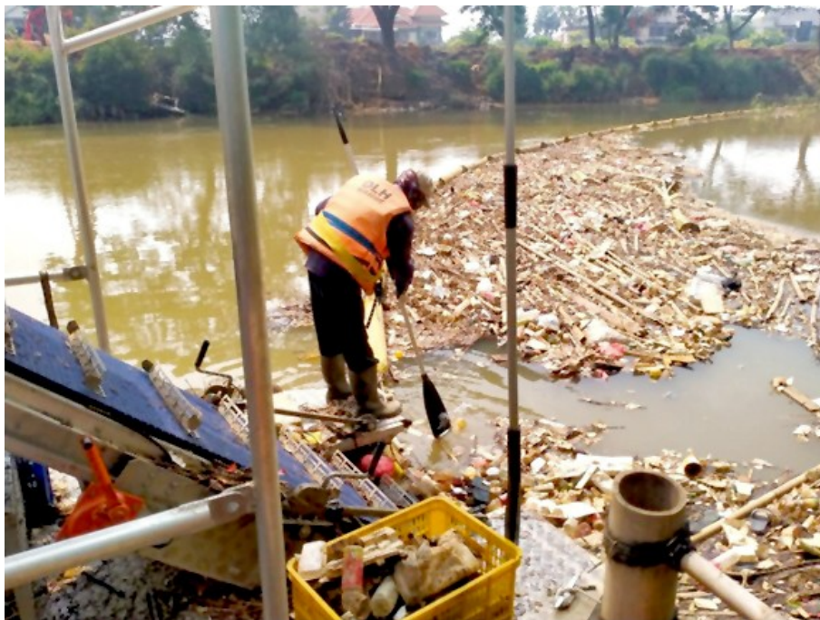
Abbildung 5.5 Einsatz einer schwimmenden festinstallierten Barriere in Kombination mit einem Müllsammelbot mit semipassivem Förderband in Jakarta
