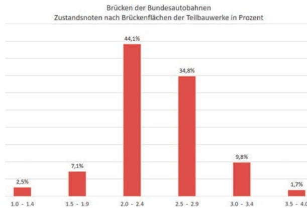
Abbildung 19 Zustand der Brücken an Bundesautobahnen Zustandsnoten nach Brückenflächen der Teilbauwerke in %, Stand 01.09.2024 Quelle: BMV
