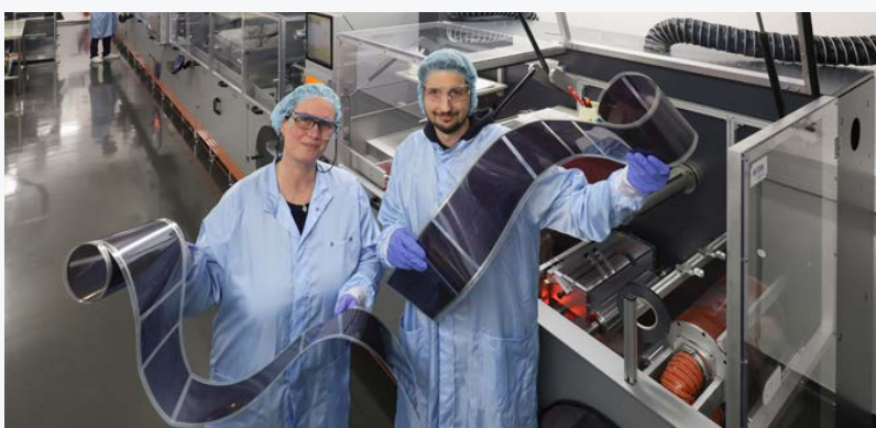
Bild links: Im Rahmen von Solar TAP werden an der Solarfabrik der Zukunft des Forschungszentrums Jülich mit Industriepartnern Technologien für das Aufskalieren von gedruckten Solarmodulen entwickelt.
